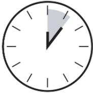
連續操作：最多可連續使用 6 分鐘。注意：每次完成碎紙動作後，碎紙機裁刀會進行簡短迅速的空轉運作以便清潔碎紙口。連續操作超過 6 分鐘即會啟動設定使碎紙機進入長達 20 分鐘的降溫狀態。
